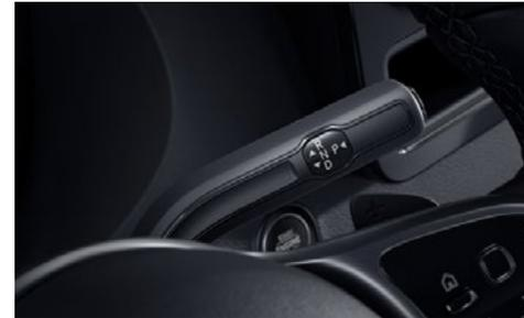
El cambio automático 9G-TRONIC\* cuenta con 9 velocidades. Permite un amplio margen de multiplicación para mantener bajo el número de revoluciones del motor e incrementar el rendimiento.
