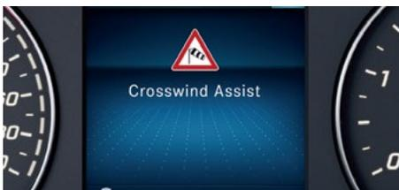
**Asistente de viento lateral.** Como equipo de serie, detecta a tiempo desvíos laterales causados por ráfagas intensas de viento lateral y asiste al conductor a mantener el vehículo en su carril.
