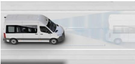
**Asistente de frenado activo.** Puede detectar peligro de colisión, emitiendo una advertencia óptica y acústica. Ante una situación de emergencia, en caso de que el conductor no tome alguna acción, puede intervenir el asistente de frenado activo.
