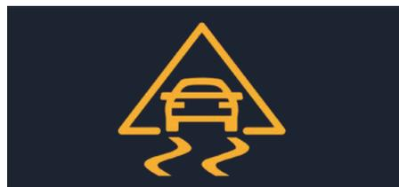
**ASR.** Si se produce resbalamiento en una de las ruedas, el ASR reduce la potencia del motor y actúa sobre los frenos para evitar que la rueda gire en vacío.
