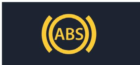
**ABS.** El sistema de antibloqueo de ruedas, hace variar la fuerza de frenado para evitar que los neumáticos pierdan adherencia con el suelo.
